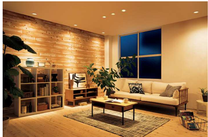
【お断り】イメージです。プランと商品が異なる場合がございます。 ダウンライト: (中央) ピッチ 300、(左壁) 壁より 300・ピッチ 1200・(右壁) 壁より 600 AAA-4973
